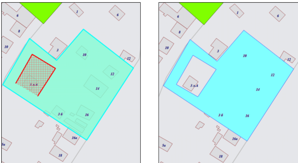
Рис. 2.143: Добавление в полигон пустоты
